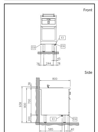
Electrical inlet (power) Equipotential screw
